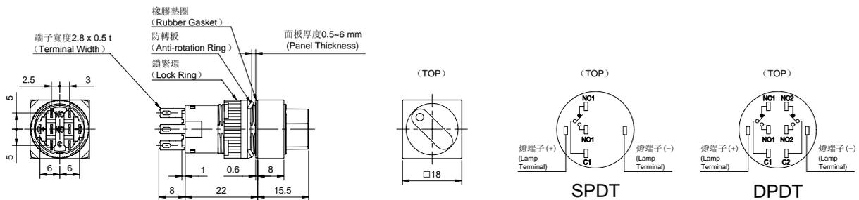
C1C 型 照光選擇開關 (LED Illuminated Selector Switches)
