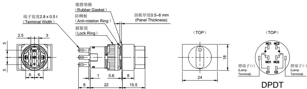
C1C 型 照光選擇開關 (LED Illuminated Selector Switches)
