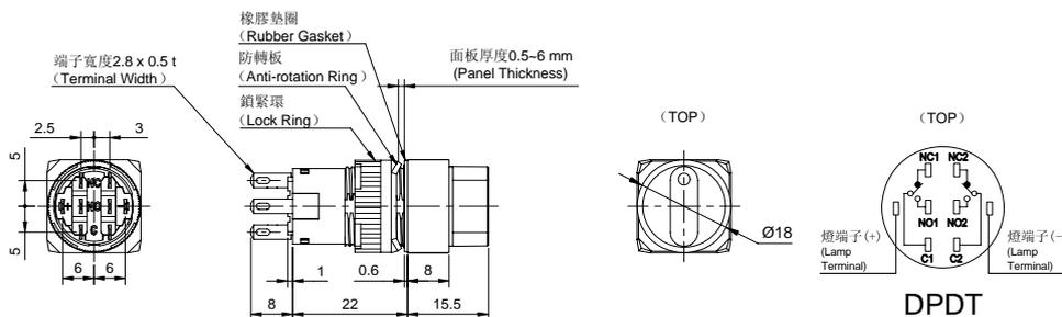
C1C C1C 型 照光選擇開關 (LED Illuminated Selector Switches)
