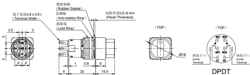
C1C 型 照光選擇開關 (LED Illuminated Selector Switches)
