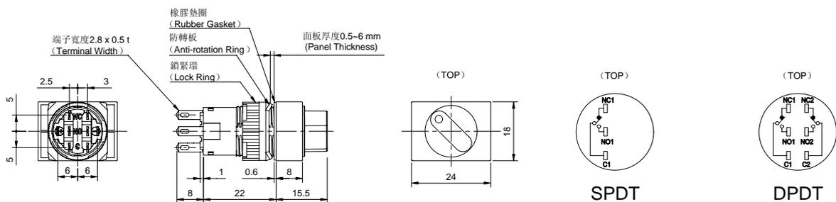
C1C C1C 型 照光選擇開關 (LED Illuminated Selector Switches)
