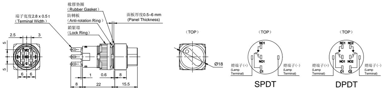
C1C C1C 型 照光選擇開關 (LED Illuminated Selector Switches)
